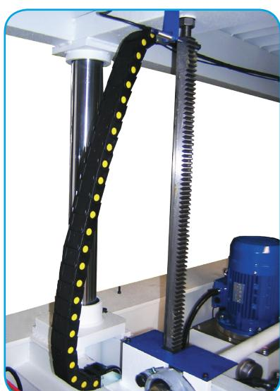
■ Tramite il controllo perimetrale è possibile controllare il perfetto parallelismo del piano mobile nelle fasi di salita e discesa. Questo controllo avviene tramite sensore posto sulla cremagliera.
