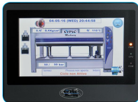
■ Вследствие постоянного исследования рынка, OMC Machinery изобрела прессы серии LOGIC CONTROL. Главная особенность заключается в наличии цифрового пульта ПЛК, с помощью которого регулируются температуры, давления, таймер автоматического открывания столов и предварительная включение системы нагревания.
